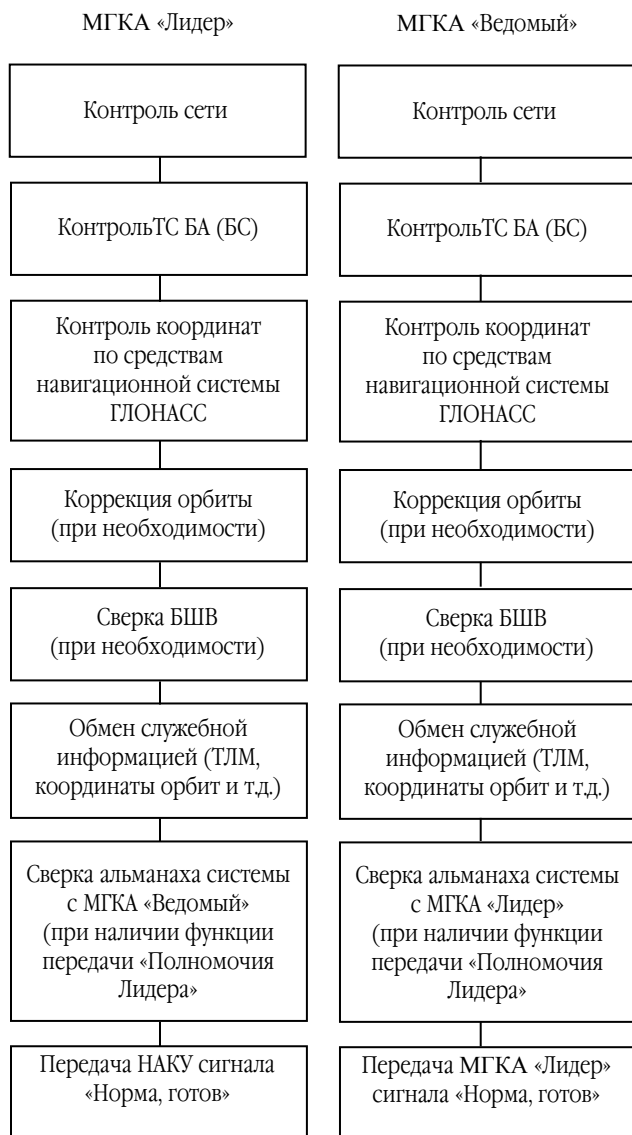
Рис.2. Дежурный режим функционирования кластера МГКА
