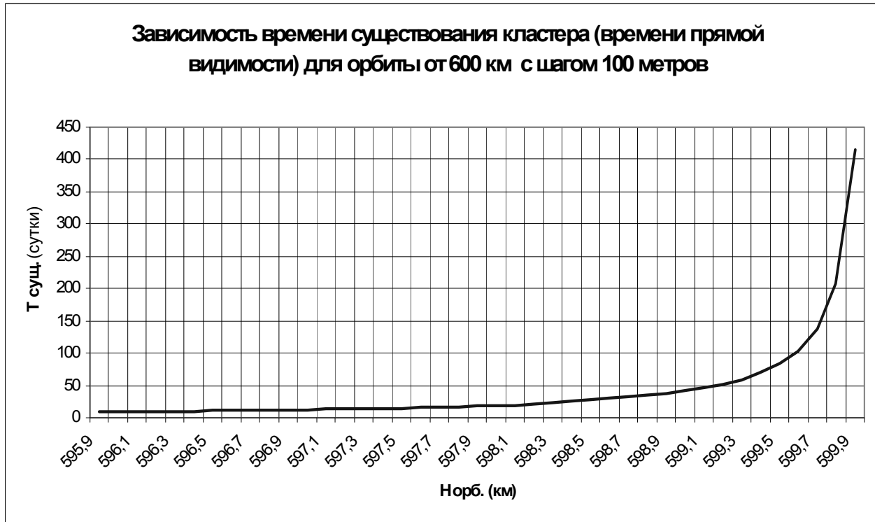
Рис. 6. Время прямой видимости между МГКА1 и МГКА2 при условии: H_1 = 600 \text{ км} - \text{const} , изменения \Delta H_2 = 100 \text{ м}
