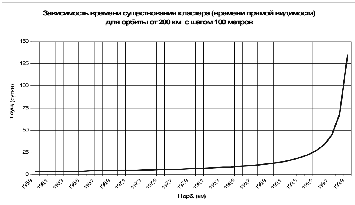
Рис. 5. Время прямой видимости между МГКА1 и МГКА2 при условии: H1 = 200 \text{ км} - \text{const} , изменения \Delta H2 = 100 \text{ м}
