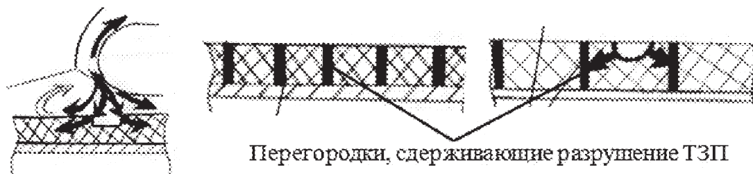
Рис. 7. Сдерживающие разрушение перегородки, интегрированные в ТЗП
