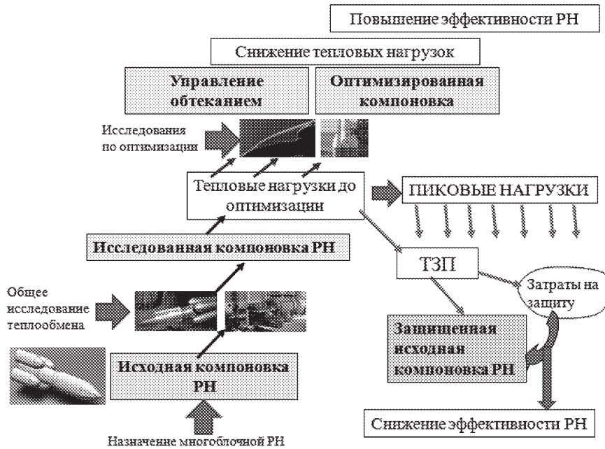
Рис. 3. Альтернативы экспериментальных исследований теплообмена многоблочных РН
