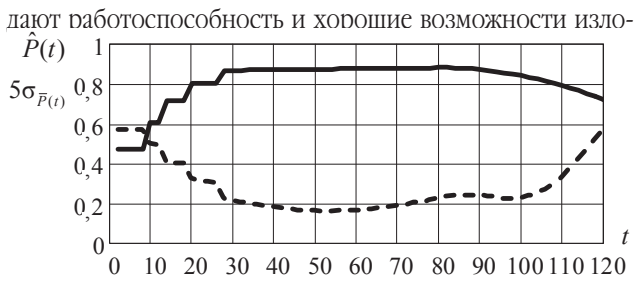
Рис. 6. Реализация оценки динамики ВБР ТС в процессе ЖЦ t в течение периода \tau=1 (сплошная) и ее СКО, увеличенное в 5 раз (пунктирная)
