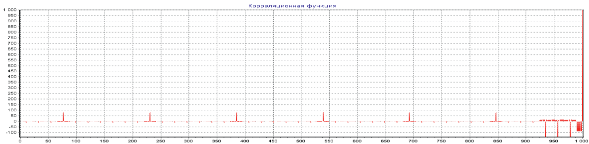
Рис. 3. Взаимно корреляционная функция для синтезированной СПСП длины N = 1001
