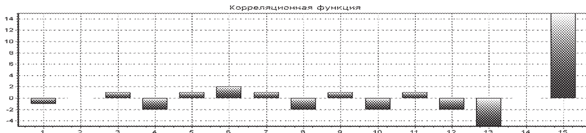
Рис. 5. Взаимная корреляционная функция (ВКФ) составного СС, принимаемого в целом без деления на части
