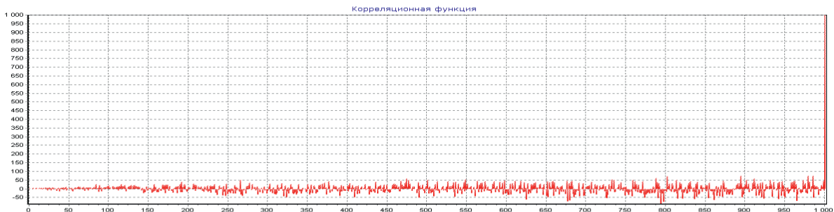
Рис.4. Взаимно корреляционная функция ПСП длины N=1001 , которая используется при передаче информации
